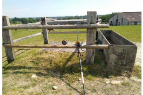
Mesure piézométrique dans un puit à Cambremer
