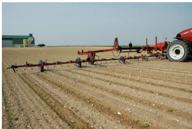
Rampe de localisation. Photo ITB.
